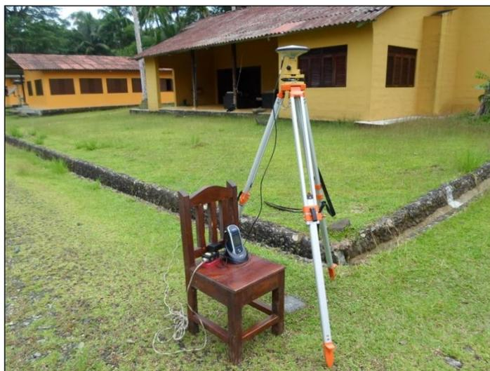
Figura 15: Ejemplo de posicionamiento GNSS en un punto de referencia monumentado en concreto
