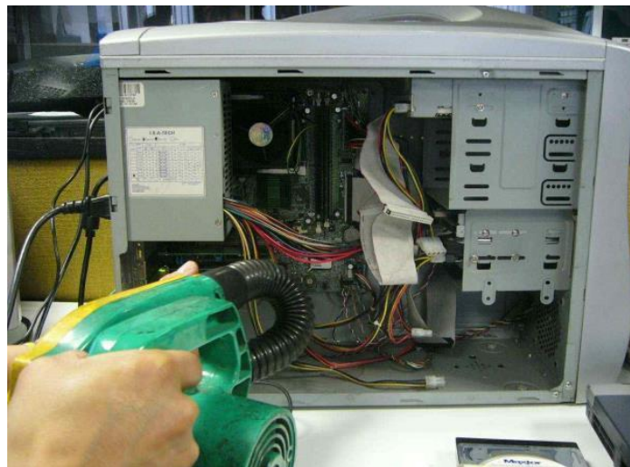
Imagen 7: Inicio de mantenimiento con limpieza
