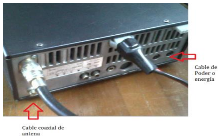
Ilustración 7 Conexiones del equipo con sus elementos (micrófono, cable coaxial-antena, cable de poder).
