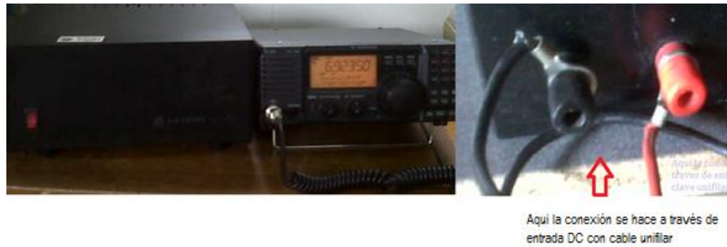
Ilustración 6 Conexión equipo base a fuente reguladora
