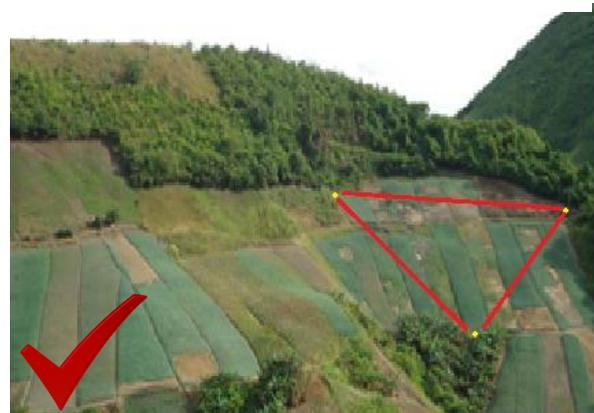
Ilustración 2 Levantamiento GPS del área Uso, con puntos 3 perimetrales (como mínimo).
