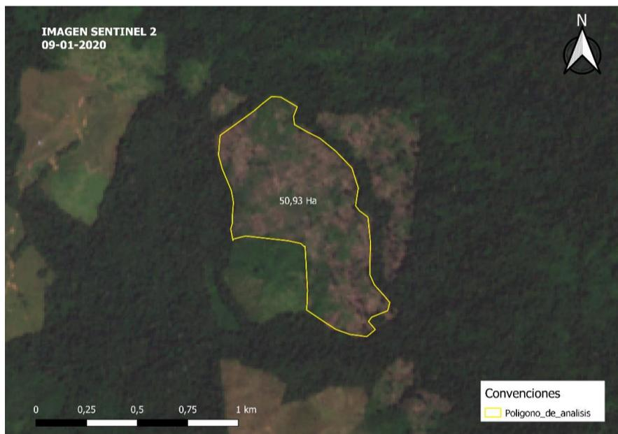
*Figura 1. El proceso inicia mediante la identificación de la pérdida de cobertura natural de bosque en las áreas protegidas de la Dirección Territorial Orinoquía mediante el uso de sensores remotos; en este caso, se identificó un área abierta de aproximadamente 50,93 Ha.*
